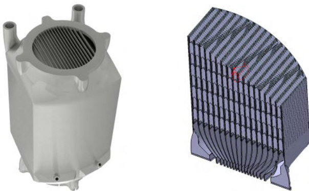
CAO - Extérieur et intérieur de la pièce imprimée en 3D
