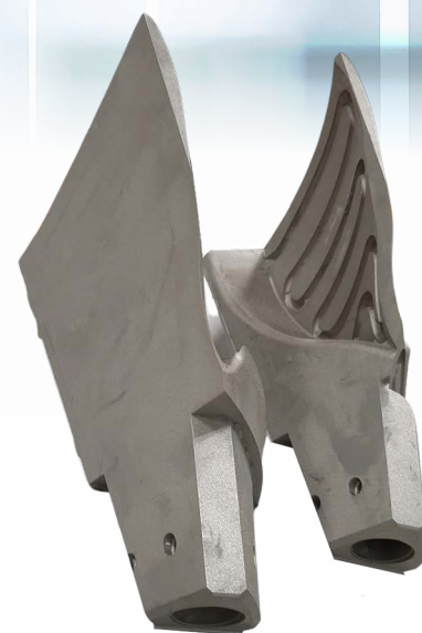
Moule d'injection imprimé en 3D avec l'acier AISI 420
